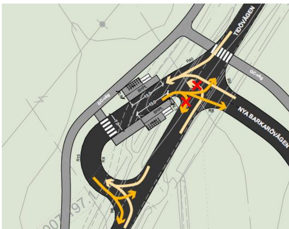
Figuren ovan visar på tänkt vändplanslösning och busshållplatser – med väderskydd och cykelparkering – vid den planerade korsningen Barkarövägen/Tidövägen. Bussar kan angöra och åka ut från alla riktningar utom på överkryssade pilar.
